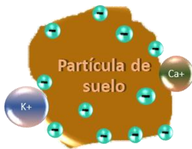
Ilustración 8: Partícula de suelo, donde se representan las cargas negativas sobre su superficie, las cuales retienen cationes.
